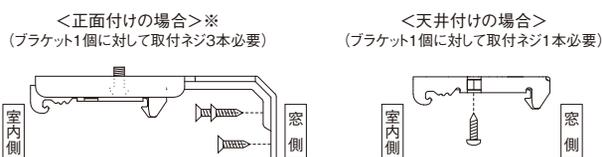
※正面付けの場合は、天井付けブラケットと正面付けL金具を組み合わせでご使用ください。天井付けブラケットを取り付ける穴は2つあり、使用する穴を変えることで壁面からの出幅調節が可能です。
